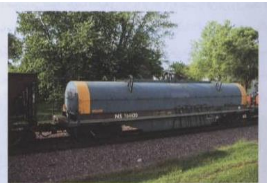
شکل ۱۵- واگن لبه کوتاه مخصوص حمل کویل
